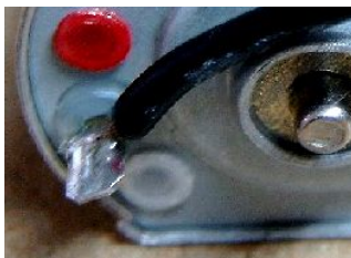
Bild 2: Kabel dicht am Gehäuse anlöten, keine überstehenden Drähte am Pol
